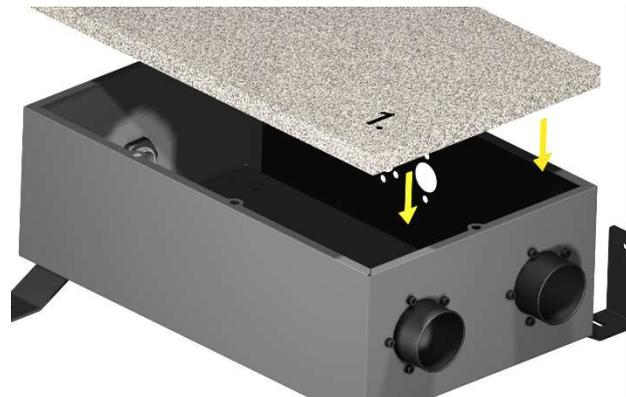
(6) Schalldämmmatte an Kabeldurchführung Kraftstoffpumpe einsetzen und Klebefolie abziehen. Gleichmäßig andrücken.
