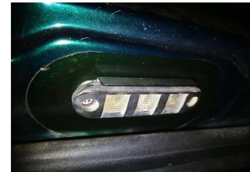
Schritt 2: Kontaktplatte heraus ziehen und Stecker lösen
