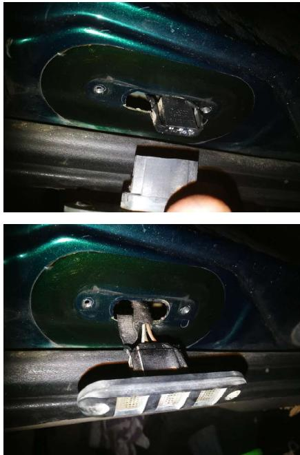
Achtung: Es kann von T4 zu T4 unterschiedliche Spaltmaße zwischen Schiebetür und B-Säule geben. Unbedingt prüfen ob Blech beim Schließen freigängig ist. Ggf. kann man die Schutzseite des Bleches abschleifen.
