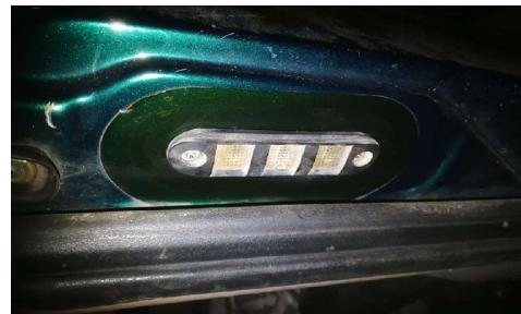
Schritt 2: Kontaktplatte heraus ziehen und Stecker lösen
